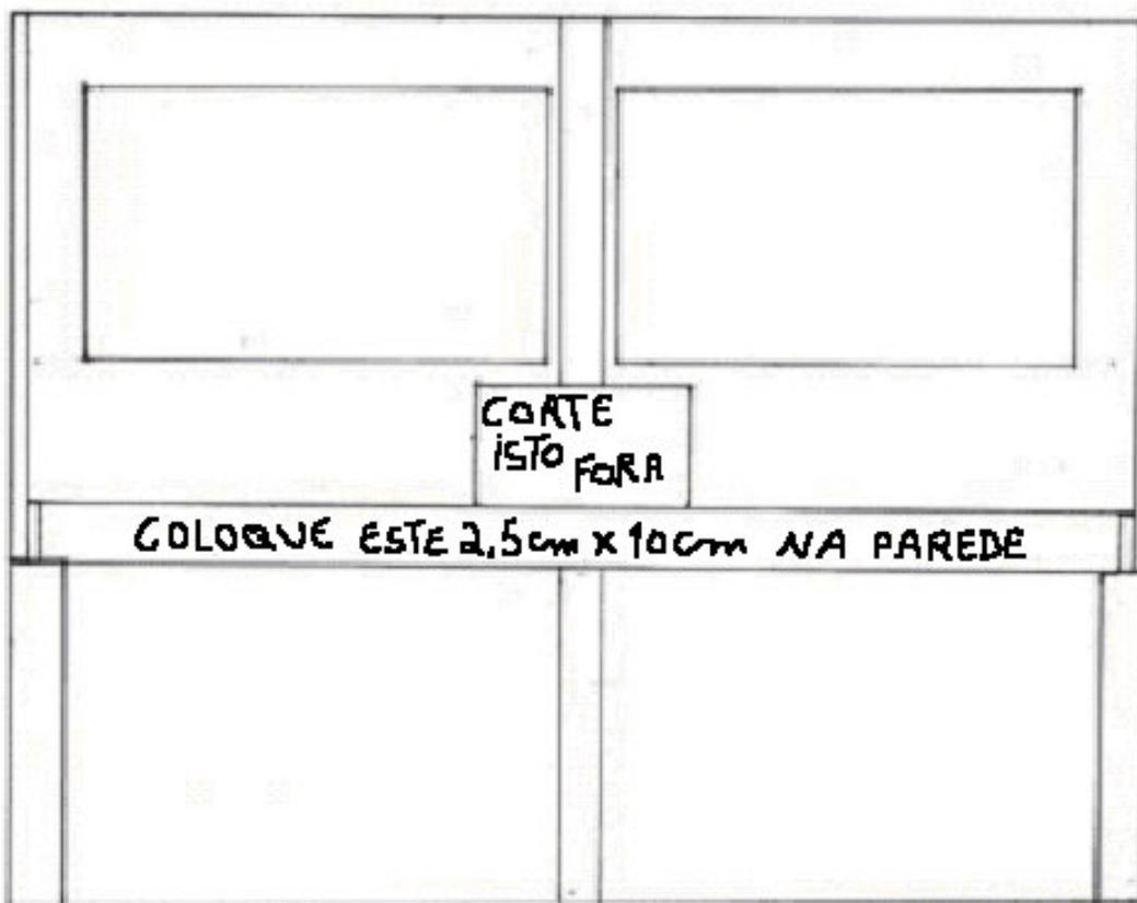
Agora acrescente um segundo 2,5 cm X 10 cm à frente do chão da passeadeira. Meça a distância entre o dianteiro 2,5 cm X 10 cm que você já instalou e a parte de trás 2,5 cm X 10 cm instalou na parede e cortou este comprimento por três pedaços de 2,5 cm X 10 cm. Os instale frente atrás para entre os dois longo 2,4 cm X 10 cm em dois centros. Assim.
