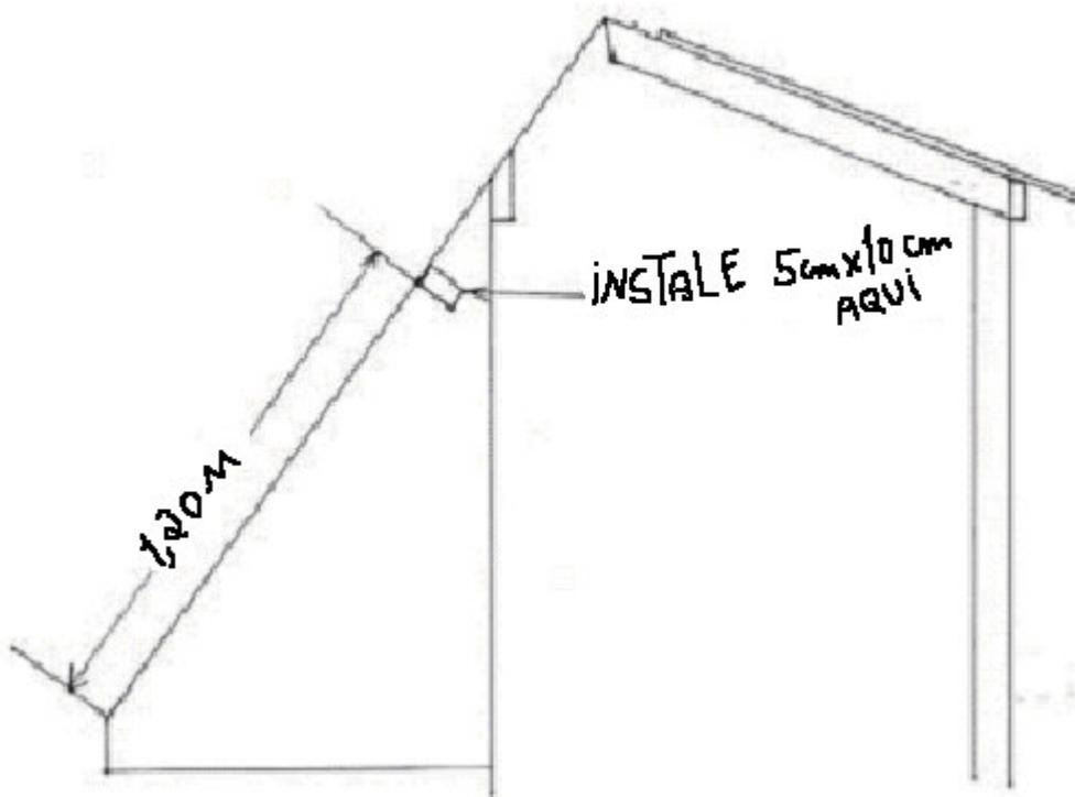
2,5 cm X 10 cm corte usando e instala um pedaço em bom estado para cada lateral da passareira e então abaixe o lado do viveiro. O pedaço lateral vertical precisa correr paralelo com a extremidade do fim de viveiro OSB. Assim.
