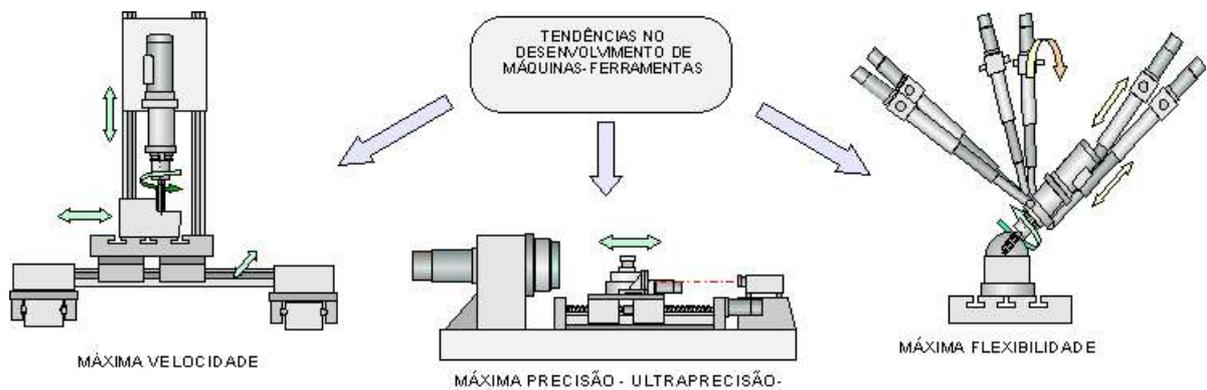
Figura I.9 – Tendências do projeto de máquinas-ferramentas
