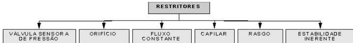
Figura 3.6 – Classificação dos mancais hidrostáticos quanto ao tipo de restritor
