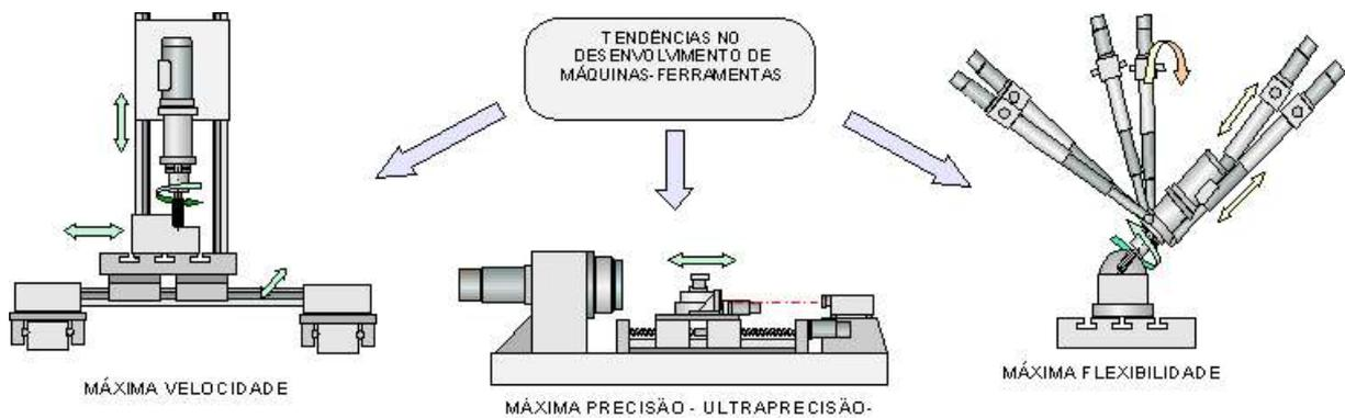
Figura I.25 – Tendências no projeto de máquinas-ferramentas
