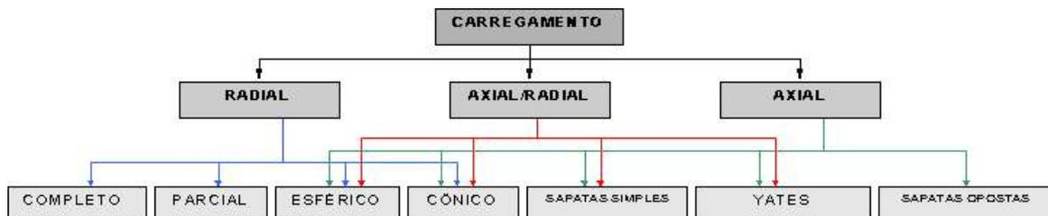
Figura 3.7 – Classificação dos mancais hidrostáticos quanto ao carregamento
