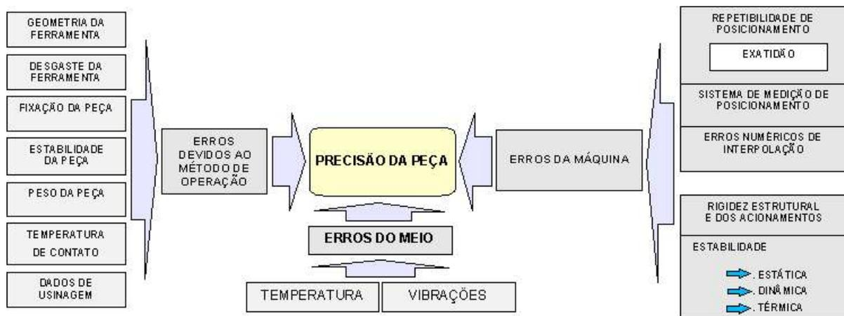
Figura I.10 - Relações que envolvem a qualidade de uma peça usinada
