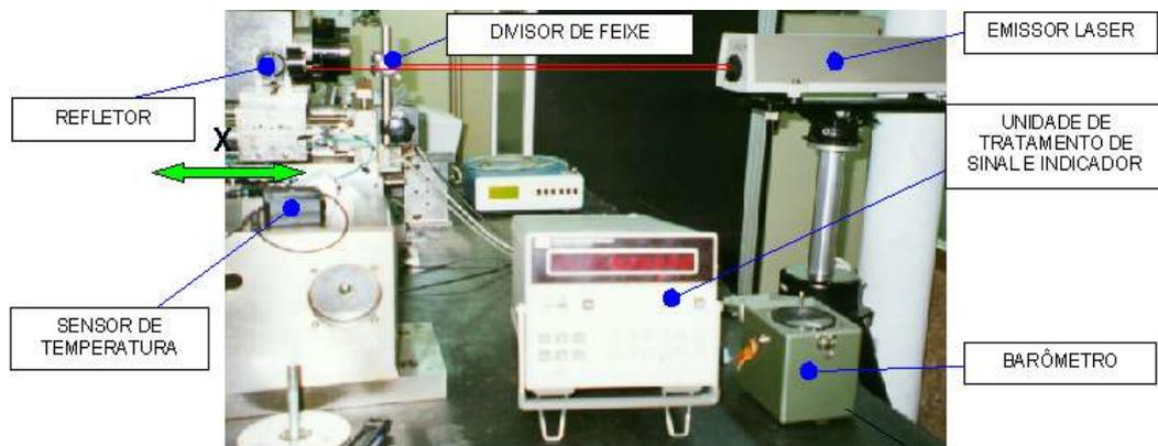
Figura 11.3 – Equipamento experimental dos ensaios de posicionamento (Stoeterau, 1999)
