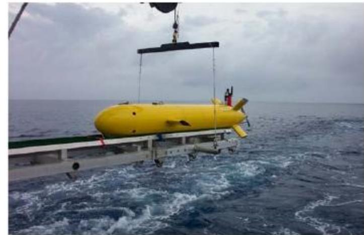
Lançamento de um AUV
