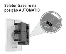
Com a chave na posição AUTOMATIC, o casamento da impedância é processado pelo SSW. Observar que os jumpers dos atenuadores deverão estar na posição: "1 VCS". Para ligação das caixas acústicas, consultar o manual do VCS.
