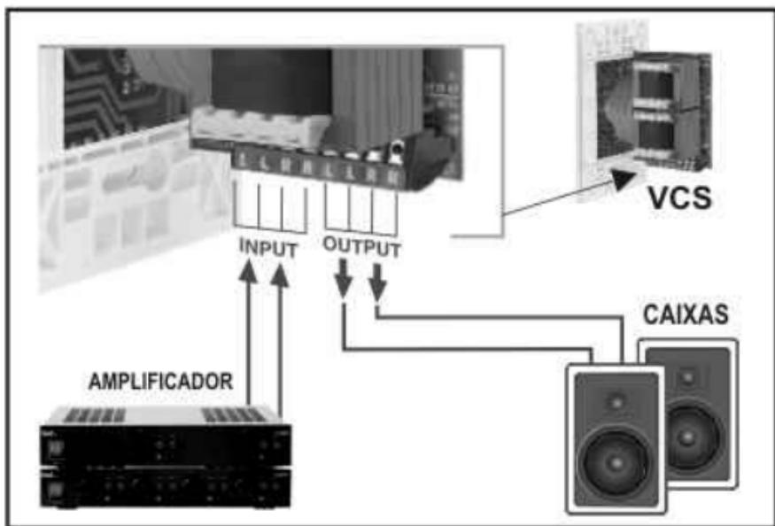
VCS 80 é dotado de conector (destacável). Primeiramente faça as ligações no conector e depois plugue ao VCS 80.
