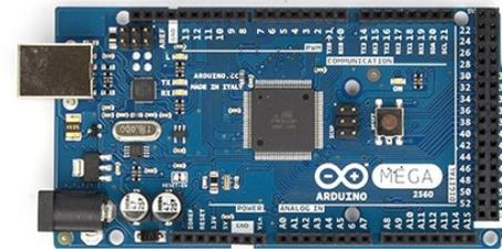
O Arduino é uma plataforma de prototipagem eletrônica que se baseia em hardware e software open-source (livre) que permitir o desenvolvimento de sistemas interativos e de controle, trata-se de uma placa de desenvolvimento com um Microcontrolador ATmega, flexível e fácil de usar, a qual você pode realizar o controle e automação de sistemas, controlando robôs, motores, lâmpadas, etc...
