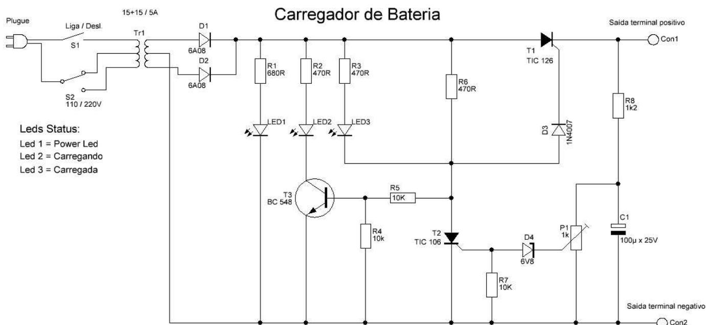
Um transformador de alta corrente abaixa a tensão CA da rede para 15 V, esta tensão é entregue ao par de diodos de alta corrente D1 e D2, que realizam a retificação da CA, fornecendo ao circuito e a bateria uma tensão CC. Estando a bateria acoplada a saída com carga muito baixa, a tensão nos terminais de saída também será baixa, com o SCR de potência TIC 126 (T1) se manterá conduzindo (com seu gate excitado via resistor de 470Ω e diodo D3 (1N4007).
