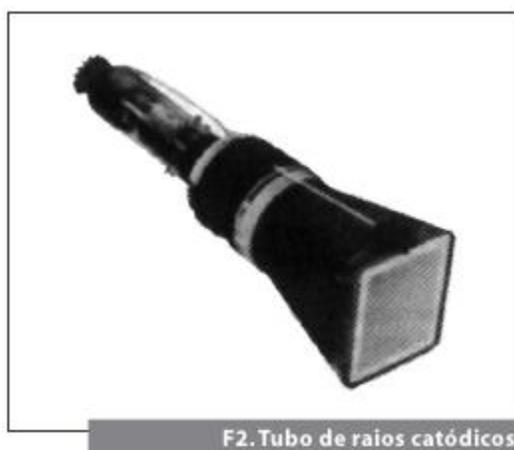
O T.R.C. é um tubo de vácuo em cujo catodo se obtém um feixe de elétrons que convenientemente acelerado, focado e orientado, se faz incidir numa tela fosforescente.
