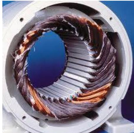
O tempo de vida operacional do enrolamento de um motor elétrico trifásico depende de vários fatores, como: especificação correta (tensão, frequência, número de pólos, grau de proteção, etc.), instalação e operação correta, etc. Caso ocorra a queima de um motor elétrico, a primeira providência a se tomar é identificar a causa (ou possíveis causas) da queima, mediante a análise do enrolamento danificado.
