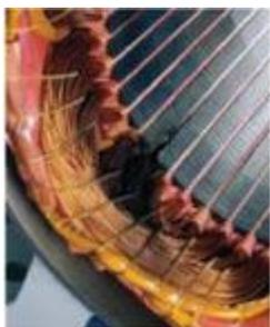
**CURTO NA SAÍDA DA RANHURA:** Contaminação interna do motor; Degradação do material isolante por ressecamento, ocasionada por excesso de temperatura. Falha do esmalte de isolamento do fio; Falha do verniz de impregnação; Falha do material isolante; Rápidas oscilações na tensão de alimentação.
