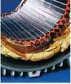
**CURTO ENTRE ESPIRAS:** Contaminação interna do motor; Falha do esmalte de isolamento do fio; Falha do verniz de impregnação; Rápidas oscilações na tensão de alimentação.
