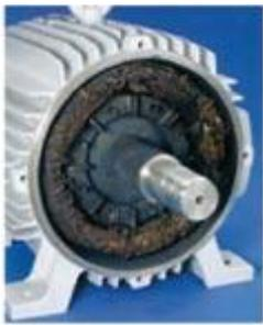
**MOTOR TRAVADO:** Excessiva dificuldade na partida do motor, devido a elevada queda de tensão, inércia e torque de carga muito elevados; Travamento do eixo da carga.
