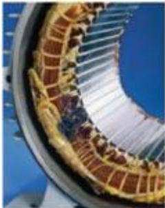
**PICO DE TENSÃO:** Motor acionado por inversor de frequência com alguns parâmetros incorretos (amplitude do pulso de tensão, rise time,  $dV/dt$ , distância entre pulsos, frequência de chaveamento); Oscilação violenta na tensão de alimentação, por exemplo, descargas atmosféricas; Surtos de manobra de banco de capacitores.
