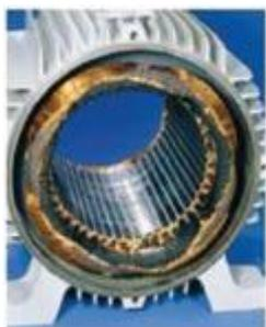
**DESBALANCEAMENTO DE TENSÃO:** Desequilíbrio de tensão e/ou de corrente entre as fases; Falha em banco de capacitores; Maus contatos em conexões, chaves, contadores, disjuntores, etc.; Oscilações de tensão nas três fases.
