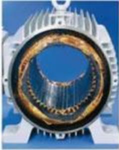
**FATA DE FASE – LIGAÇÃO EM TRIANGULO:** Mau contato em chave, contator ou disjuntor; Mau contato em conexões; Mau contato nos terminais de uma fase do transformador; Queima de uma fase do transformador de alimentação; Queima de um fusível; Rompimento de um cabo alimentador.
