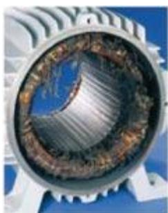
**SOBREAQUECIMENTO:** Cabos de alimentação muito longos e/ou muito finos; Conexão incorreta dos cabos de ligação do motor; Excessivo número de partidas em tempo curto; Excesso de carga na ponta de eixo (permanente ou eventual/periódico); Sobretensão ou subtensão na rede de alimentação (permanente ou eventual/periódico); Ventilação deficiente (tampa defletora danificada ou obstruída, sujeira sobre a carcaça, temperatura ambiente elevada, etc.).
