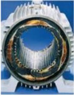
**FALTA DE FASE – LIGAÇÃO EM ESTRELA:** Mau contato em chave, contator ou disjuntor; Mau contato em conexões; Mau contato nos terminais de uma fase do transformador; Queima de uma fase do transformador de alimentação; Queima de um fusível; Rompimento de um cabo alimentador.
