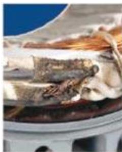
**CURTO NA CONEXÃO:** Contaminação interna do motor; Falha do material isolante; Superaquecimento da conexão devido a mau contato.
