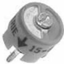
Construção similar (mas com apenas duas placas) pode ser usada em pequenos capacitores ajustáveis (trimmer, padder).
