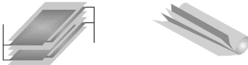
De forma idêntica, encontramos os capacitores eletrolíticos de tântalo, onde o dielétrico é formado por óxido de tântalo, cuja constante dielétrica faz obter-se um capacitor de pequenas dimensões, porém com valores de tensão de isolamento, mais limitados.
