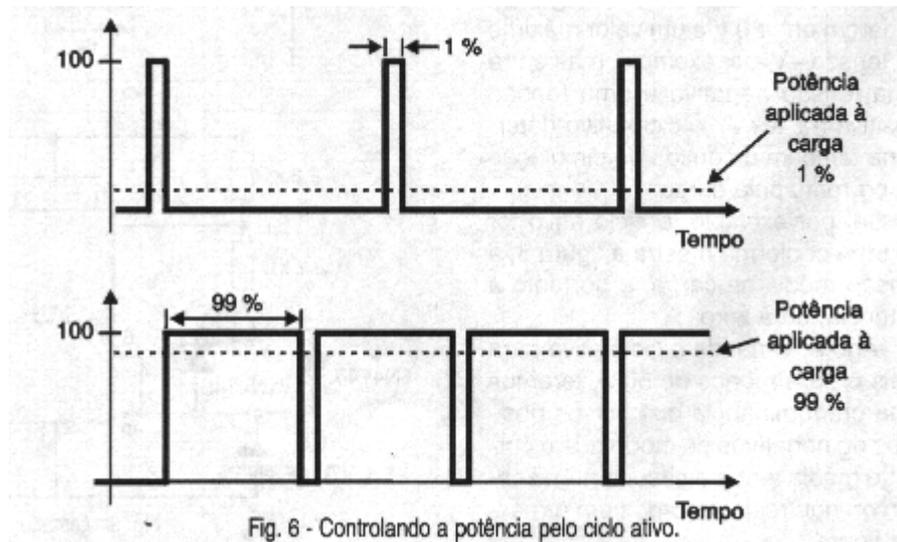
Este princípio é usado justamente no controle PWM: modulamos (variemos) a largura do pulso de modo a controlar o ciclo ativo do sinal aplicado a uma carga e, com isso, a potência aplicada a ela.
