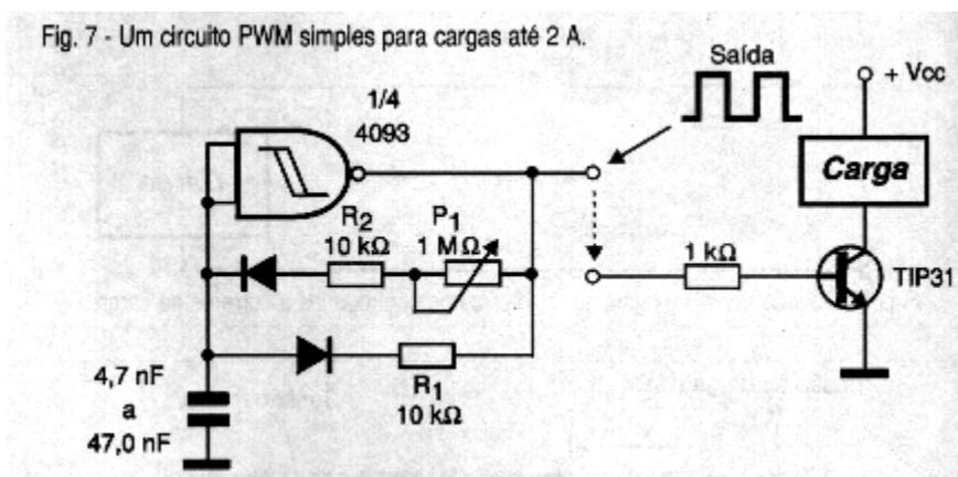
O oscilador, montado com um circuito integrado 4093 tem sua saída no nível alto determinada pelo ajuste do potenciômetro, enquanto que sua saída no nível baixo é determinada pelo resistor R1 (fixo). Assim, fazendo R1 suficientemente pequeno em relação ao valor do potenciômetro, o circuito poderá gerar sinais numa ampla faixa de ciclos ativos.
