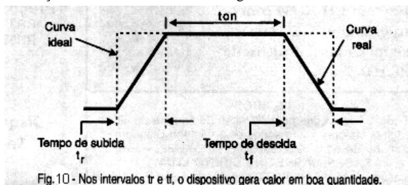
Neste intervalo de tempo a queda de tensão e a corrente através do dispositivo não são nulas, e uma boa quantidade de calor poderá ser gerada conforme a carga controlada.
