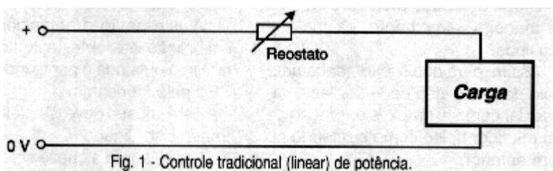
Variando-se a resistência apresentada pelo reostato pode-se modificar a corrente na carga e, portanto, a potência aplicada a ela. Este tipo de controle ainda é encontrado nas lâmpadas de painéis de alguns carros mais antigos.
