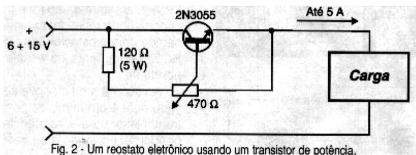
Embora o potenciômetro usado no controle dissipe pequena potência, pois a corrente nele é menor, este tipo de controle ainda tem um problema: a potência dissipada pelo dispositivo que controla a corrente principal é elevada.
