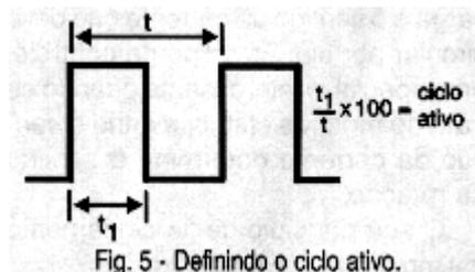
Variando-se a largura do pulso e também o intervalo de modo a termos ciclos ativos diferentes, podemos controlar a potência média aplicada a uma carga. Assim, quando a largura do pulso varia de zero até o máximo, a potência também varia na mesma proporção, conforme está indicado na figura 6.
