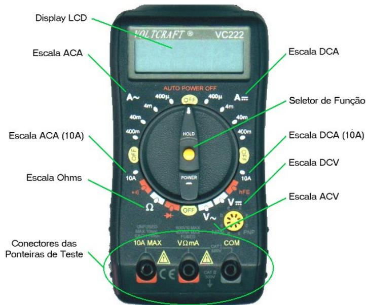
Figura 4: Foto de um multímetro VOLTcraft com auto-range.
