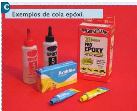
A cola epóxi é fornecida em duas partes: o adesivo e o “acelerador” ou catalisador. Para usar basta misturar partes iguais de ambos, misturando bem até ela ficar homogênea. A aplicação deve ser feita em no máximo 3 minutos (para colas de 15 minutos de secagem) com o uso de uma espátula plástica ou mesmo um pedaço de madeira (sobra). Veja as **figuras D a H**.
