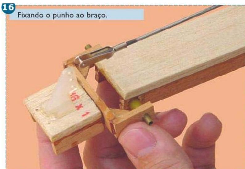
Fixe o servo da garra ao punho. Utilize para isso dois parafusos de madeira. Note que o servo será fixado de "cabeça-para-
