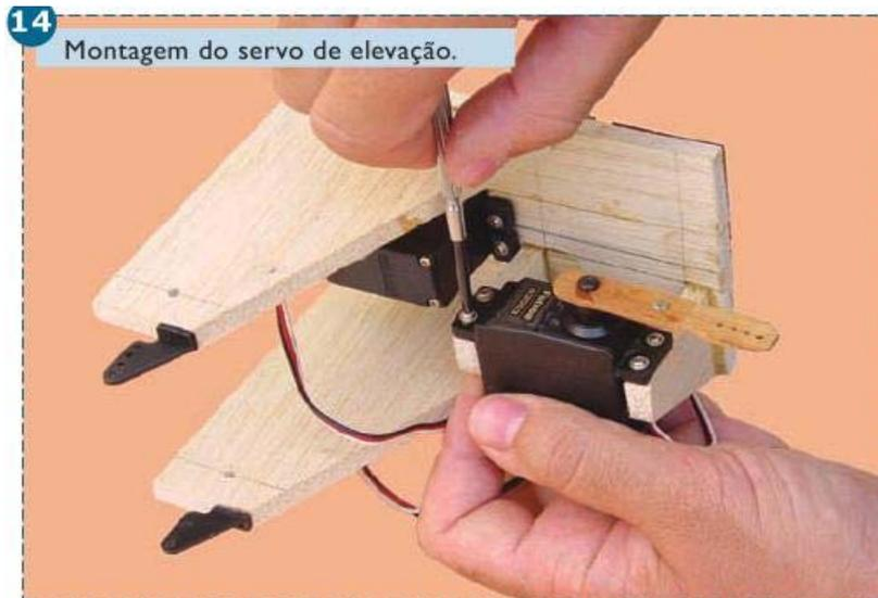
O servo de elevação precisa ter sua "alavanca" de comando aumentada. Para isso utilizamos cedro com 2 mm de espessura com largura de 10 mm. A **figura 15** traz as partes necessárias para a alavanca de elevação.
