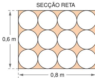
a) Cada embalagem cilíndrica terá  $0,8 : 4 = 0,2$  m de diâmetro, portanto  $0,1$  m = 10 cm de raio.
