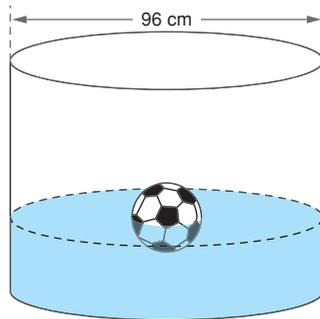
O volume de água deslocada ( $V_1$ ) equivale ao volume da semi-esfera ( $V_2$ ) que ficou submersa.
