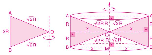
O volume  $V$  desse sólido é dado pela diferença entre o volume de um cilindro circular reto de altura  $2R$  e raio da base  $x$ , e o volume de dois cones retos congruentes de altura  $R$  e raio da base  $x$ , em que  $x$  é a distância entre o ponto  $O$  e a reta  $\overline{AB}$ .
